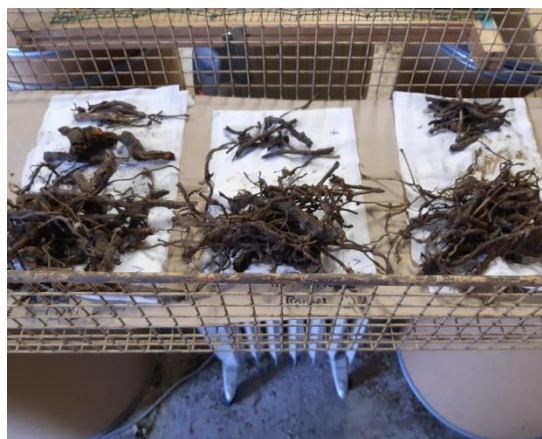
Fig. 14 : Deuxième séchage à 40°C des biomasses, 18/12/24
