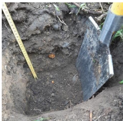
Fig. 11 : Prélèvement pour quantifier la biomasse souterraine des 30 premiers centimètres, 28/10/25
