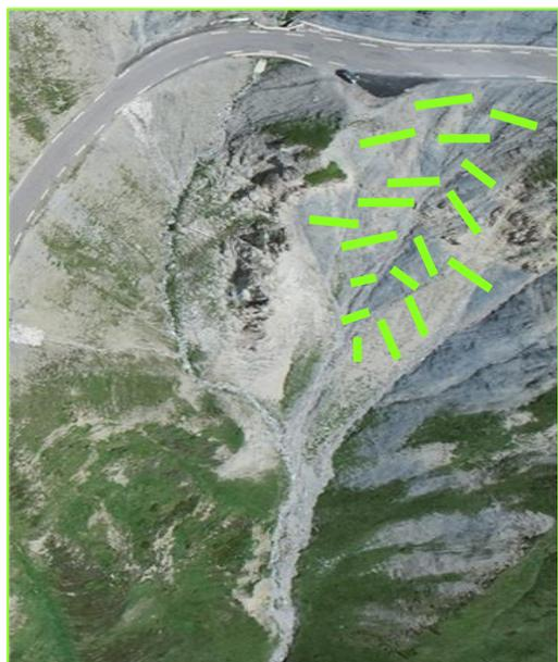
Figure 21 : Localisation des structures antiérosives en dessous du pont de la route (28/06/24).
