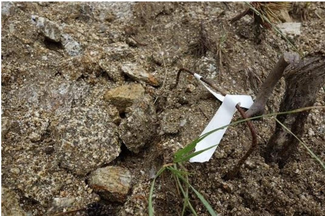
Figure 53 : Utilisation d'agrafes métalliques pour évaluer les volumes de terre déplacés par l'érosion (Les Angles, 25/06/2017)
